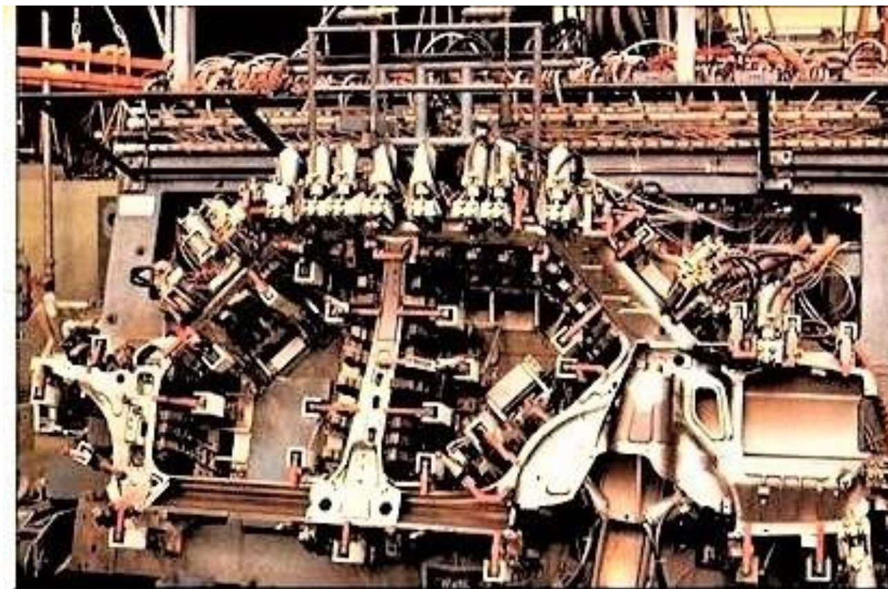
Una multisaldatrice all'opera sulla fiancata di una Acclaim.
