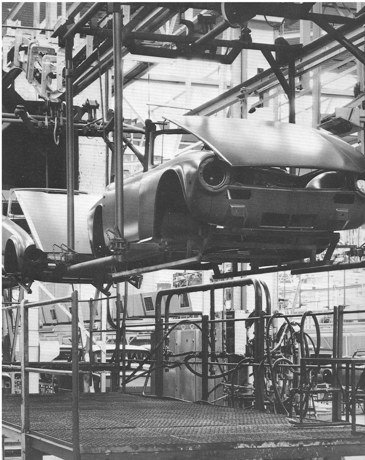
Una GT6 Mk3 sulla la linea di verniciatura che era eseguita completamente a mano e in atmosfera protetta.
