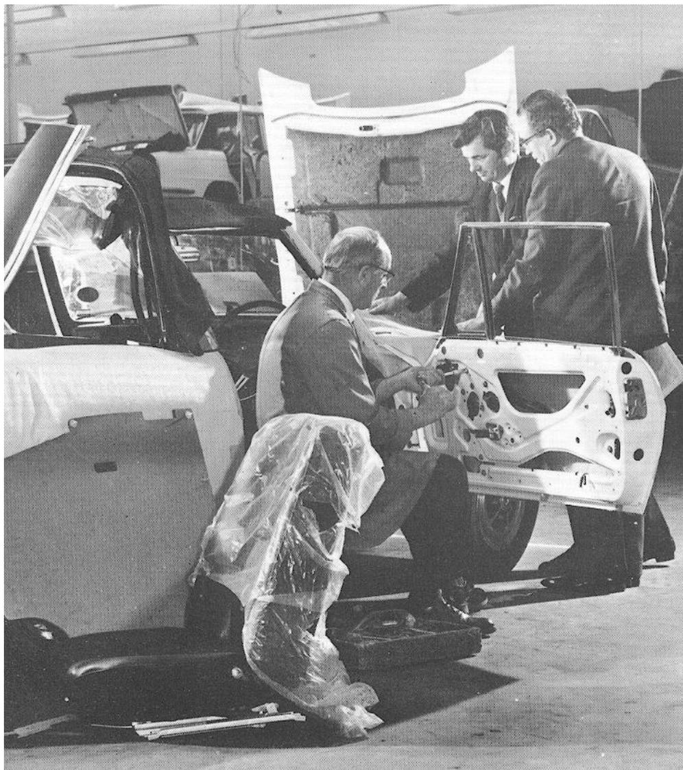
Due ingegneri al controllo dell'avanzamento dei lavori per la preparazione di un prototipo, questa volta metallico e costruito completamente a mano.
