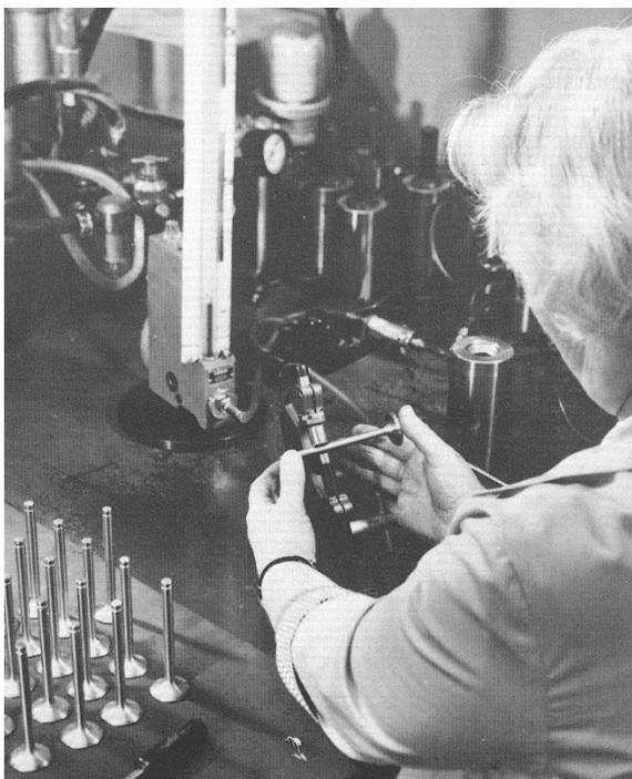
Anche se le tolleranze degli steli di queste valvole erano controllati dal fornitore prima della consegna, a Canley si provvedeva a un ulteriore successivo controllo.
