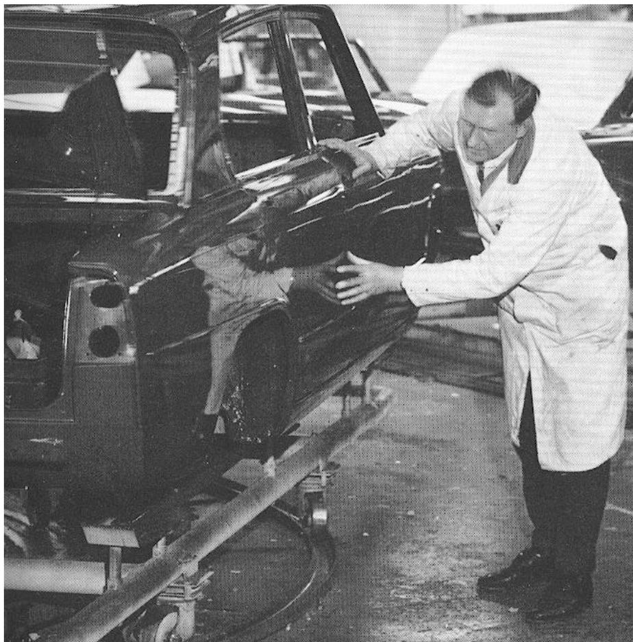
Un ispettore dedicato al controllo di qualità della verniciatura: le auto erano sottoposte a queste verifiche prima di essere avviate verso il montaggio della componentistica. La presenza di eventuali difetti riportava le auto nel reparto carrozzerie.
