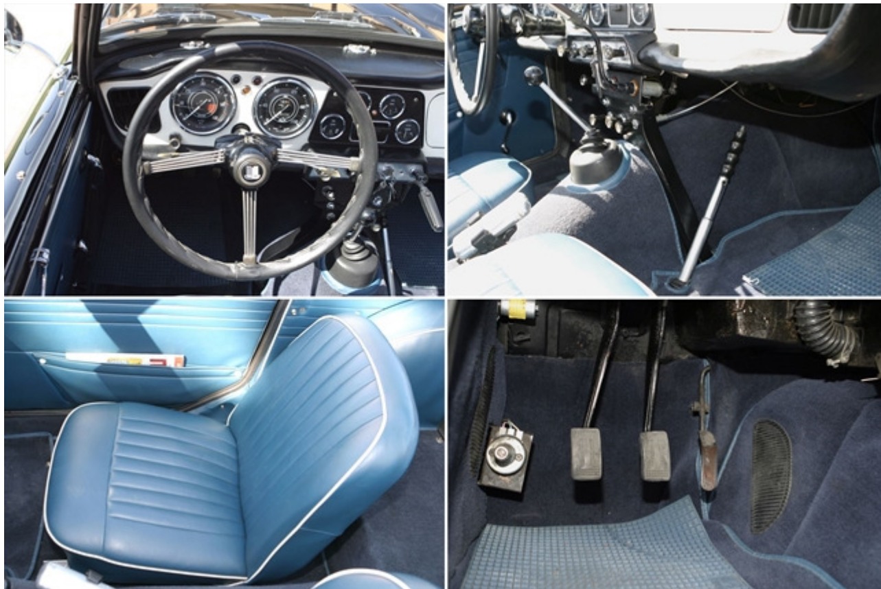
Un'occhiata agli interni. Il volante a tre razze con i due grossi "orologi" per il contagiri e il tachimetro. La leva del cambio sulla "gobba" che ospita la trasmissione. La pedaliera. Gli interni in finta pelle, con materiali e finiture che rispettano l'originalità.
