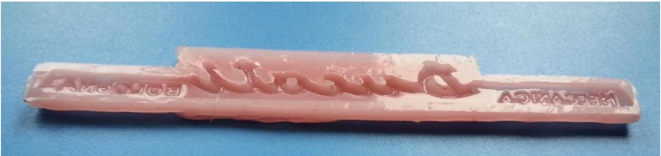
Il risultato finale è stato più che deludente perché nel processo di vulcanizzazione dello stampo per la Zama il positivo in resina si è distorto creando di conseguenza un calco difettoso, da cui una successiva fusione inutilizzabile.
