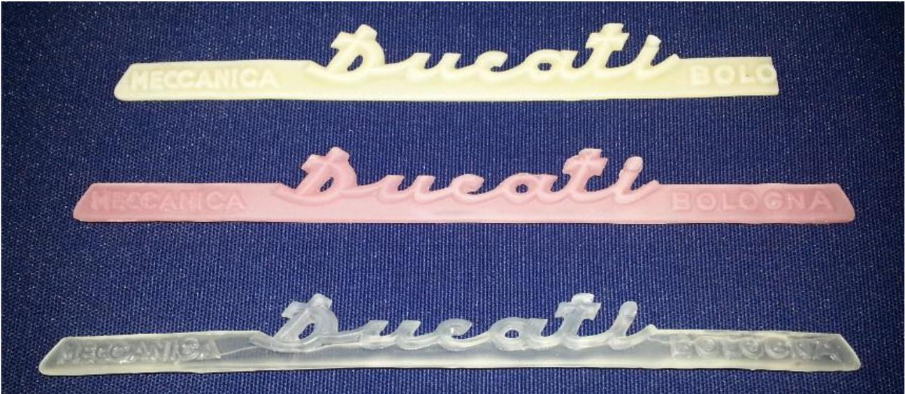
Ci siamo resi conto che queste resine hanno dei valori di resistenza meccanica che diminuiscono all'aumentare della temperatura, mentre invece non hanno presentato problemi di deformazioni al solo calore, almeno alle temperature raggiunte dalla vulcanizzazione e da noi simulate.
