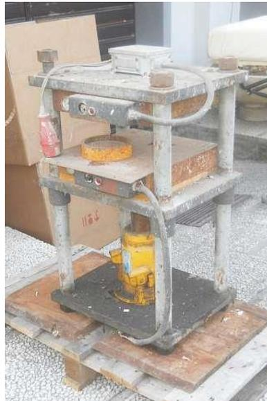
superiore le due piastre che, riscaldate, vulcanizzano la gomma. Nella fase di realizzazione dello stampo si raggiunge la temperatura di 170/180°C e pressioni di 150-200 atm. Lo stampo circolare in gomma siliconica vulcanizzata pronto per la fusione: si possono osservare le impronte degli oggetti e i canali realizzati per la colata interna. A destra lo stesso stampo chiuso.
