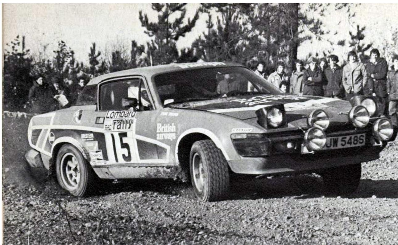
Ma veniamo alla nostra SJW 548S. Questa Works Rally car venne costruita nel 1978 a seguito della omologazione da parte della BL del motore V8 di origine Buick-Rover di 3,5 litri che equipaggiava le berline Rover dell'epoca. Si trattava di un motore V8 con un albero a camme per bancata che, nella versione standard a carburatori (una coppia di SU H6) della berlina Rover, forniva la modesta
