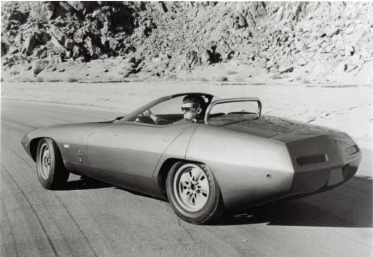
Peter invece iniziò ad occuparsi della carrozzeria che doveva essere in leggeri pannelli di alluminio. Prese contatti con la Borth&Rose in California per iniziare lo stampo della pannellatura. Per risolvere il problema del parabrezza, che nei suoi bozzetti aveva una forma aerodinamica estremizzata, fece ricorso alle sue conoscenze presso la Hino per ottenere il parabrezza della Samurai GT che aveva qualche somiglianza con quello da lui disegnato. Il lavoro andava un poco a
