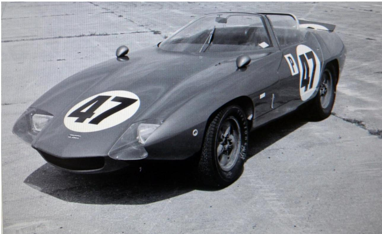
Meccanicamente, il prototipo fu costruito molto bene e garantiva già da subito una buona confidenza con il pilota; qualche problema all'impianto frenante fu risolto con la sostituzione della pompa dei freni, utilizzandone una diversa con il diametro del pompante maggiorato. La vita sportiva della TR250K fu praticamente condensata in una sola gara, la partecipazione alla 12 ore di
