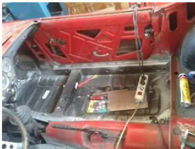
Con nuovo entusiasmo, ripresi il mio lavoro con la convinzione che niente, da adesso in avanti, mi avrebbe potuto più fermare. Saldato completamente il primo fondo creai la giunzione con il sottoporta interno e rimontai la portiera in modo da controllarne l'allineamento.
