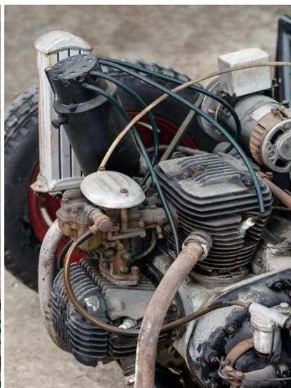
*Sopra e nella pagina seguente, alcune immagini del prototipo della Ducati D4 dotato di un motore a quattro cilindri a V di 90° e di trazione anteriore. Non è noto il nome del progettista, ma in quel periodo in Italia esisteva un unico progettista con esperienza sia sulla trazione anteriore che sui motori raffreddati ad aria: Oreste Lardone, che in quel periodo, prima di essere richiamato in Fiat da Dante Giacosa, collaborava con diverse aziende piemontesi di motociclette.*
