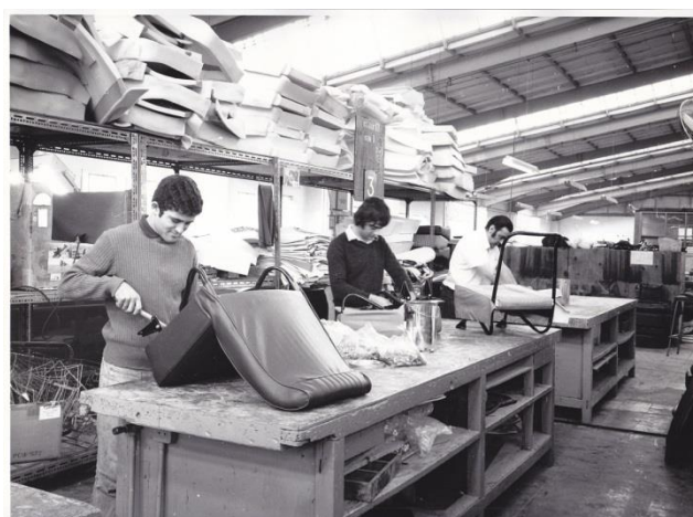
Ecco come giungevano dall'Inghilterra le diverse parti degli interni e come venivano assemblate.
