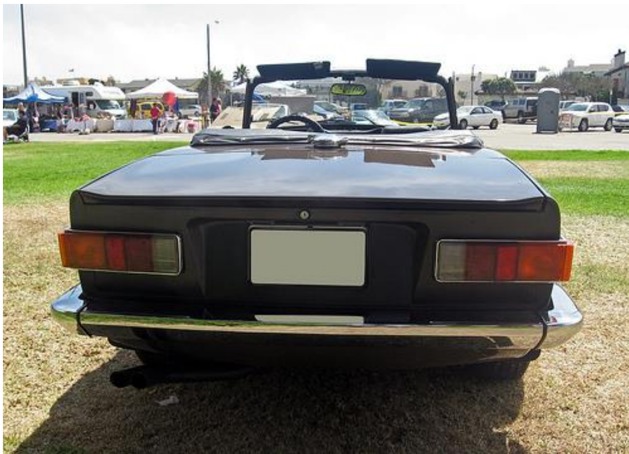
Questa è una Triumph TR6 nordamericana del 1975, ma l'attuale proprietario ha evidentemente eliminato i rostri del paraurti e, se gli occhi non ci ingannano, gli spessori che normalmente aumenterebbero l'altezza di marcia (foto dell'autore).
