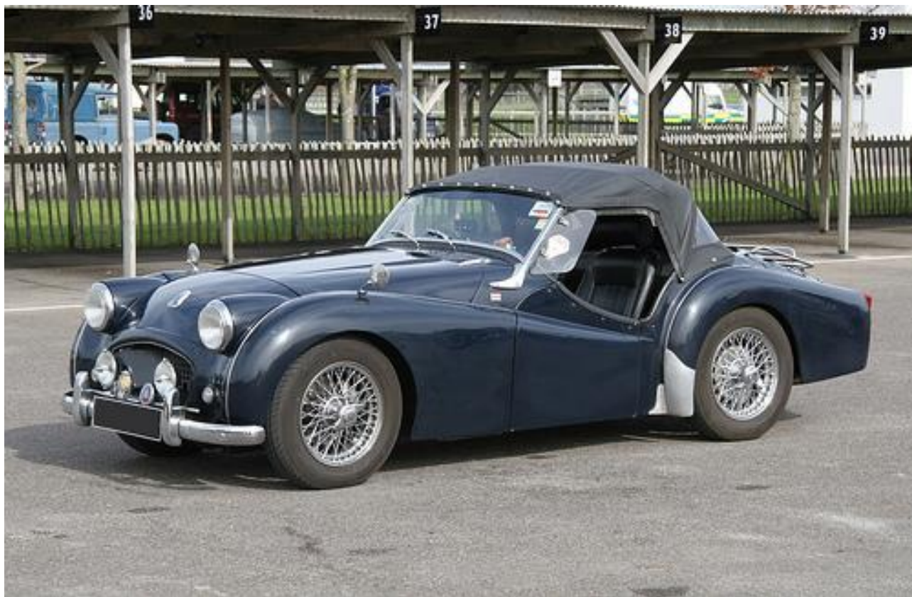
La Triumph TR2. Da notare la griglia (modificata nella TR3 nel corso del 1955), parabrezza asportabile, le porte "cutaway". Tra il 1953 e la fine del 1955 furono prodotte un totale di 8628 TR2. (Foto: "Triumph TR2" © 2008 Brian Snelson; modificata nel 2014 da Aaron Severson per nascondere la targa e utilizzata secondo la licenza Creative Commons Attribution 2.0 Generic con modifiche consentite dalla licenza stessa)
