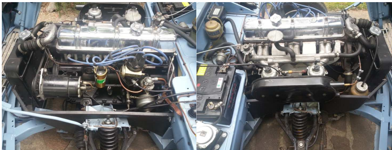
Il motore a 6 cilindri qui nella versione di 2 litri alloggiato nella GT6.
