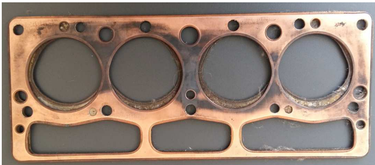
Sovrapponendo le guarnizioni della testa dei motori 948 (sotto) e 1147 (sopra) si può notare il disassamento dei quattro cilindri; le posizioni dei prigionieri della testa rimangono invariate.
