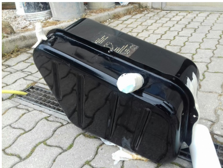
A sinistra: il serbatoio pronto per l'antiruggine. A destra: la situazione del fondo dopo il trattamento.
