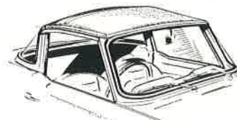
Il 'Surrey Top' (baldacchino ribaltabile di polivinile) si attacca rapidamente nella sua posizione per proteggere da subitanei cambiamenti di tempo.
