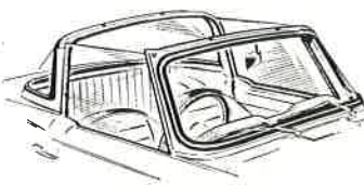
Pannello di tetto smontato: il parabrezza fisso e la finestra posteriore rimangono in posizione per marciare all'aria aperta senza correnti.
