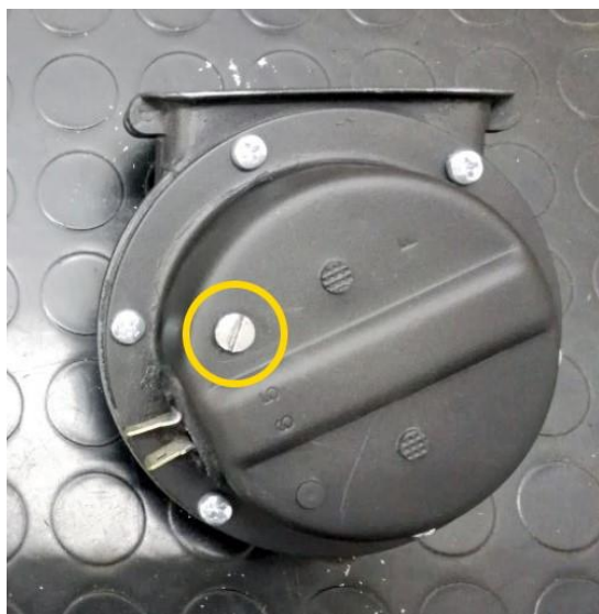
A sinistra, in evidenza la vite di regolazione del tono. A destra, tre dei sei rivetti che chiudono la tromba.
