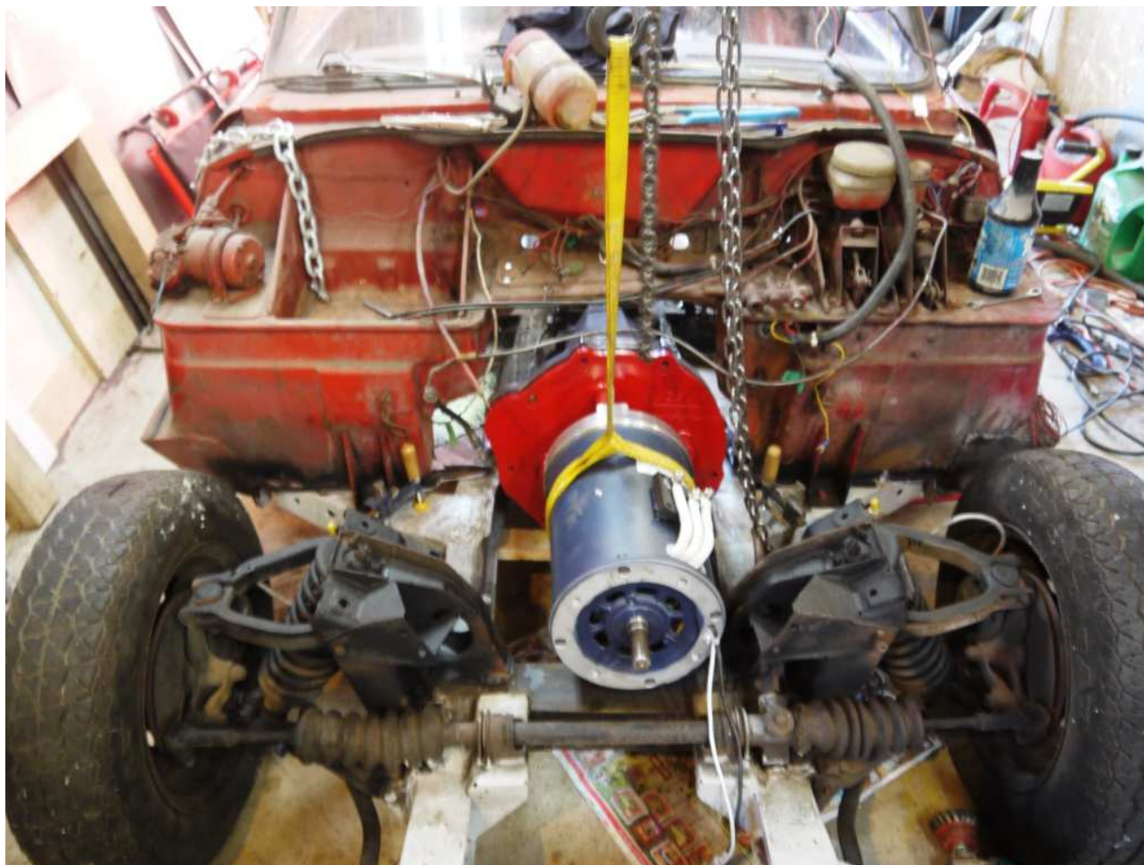
Il motore AC-50 (blu/argento) collegato alla piastra di montaggio del cambio CanEV (rosso).
