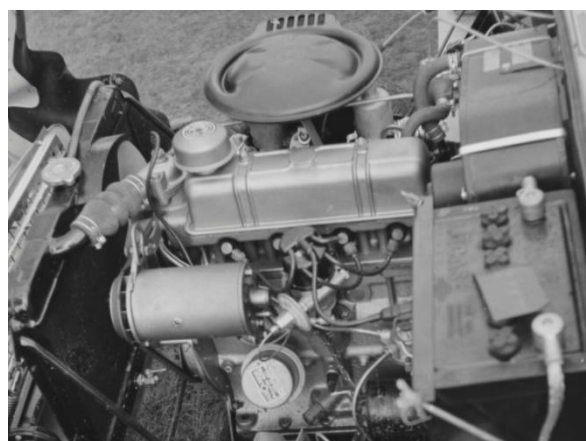
Due immagini del piccolo motore di 948 c.c. ereditato dalla Standard 10 e del frontale che, incernierato anteriormente, garantiva una eccezionale accessibilità al motore.
