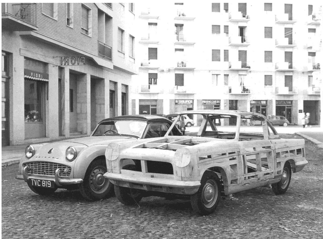
Torino, 1957: il mascherone della Herald realizzato da Ghirardotto. Sarà la Carrozzeria Vignale a battere la lamiera dei primi prototipi.
