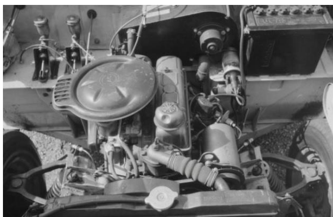
Due immagini del piccolo motore di 948 c.c. ereditato dalla Standard 10 e del frontale che, incernierato anteriormente, garantiva una eccezionale accessibilità al motore.
